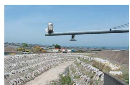
水位・流速計。川の水量の変化や流れの速さの変化で土石流発生を監視できることから、超音波を用いた水位計や電磁波を用いた流速計を設置しています。水位の急激な上昇は、川の流れに、土石が加わった可能性が高いことを示します。
