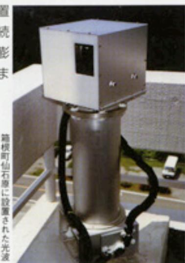
測量器（箱根町・仙石原に設置された光波測量器）
